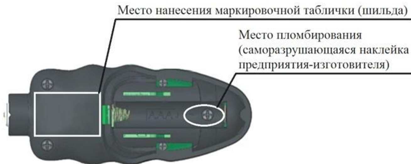
Рисунок А.1 – Схема пломбировки от несанкционированного доступа
