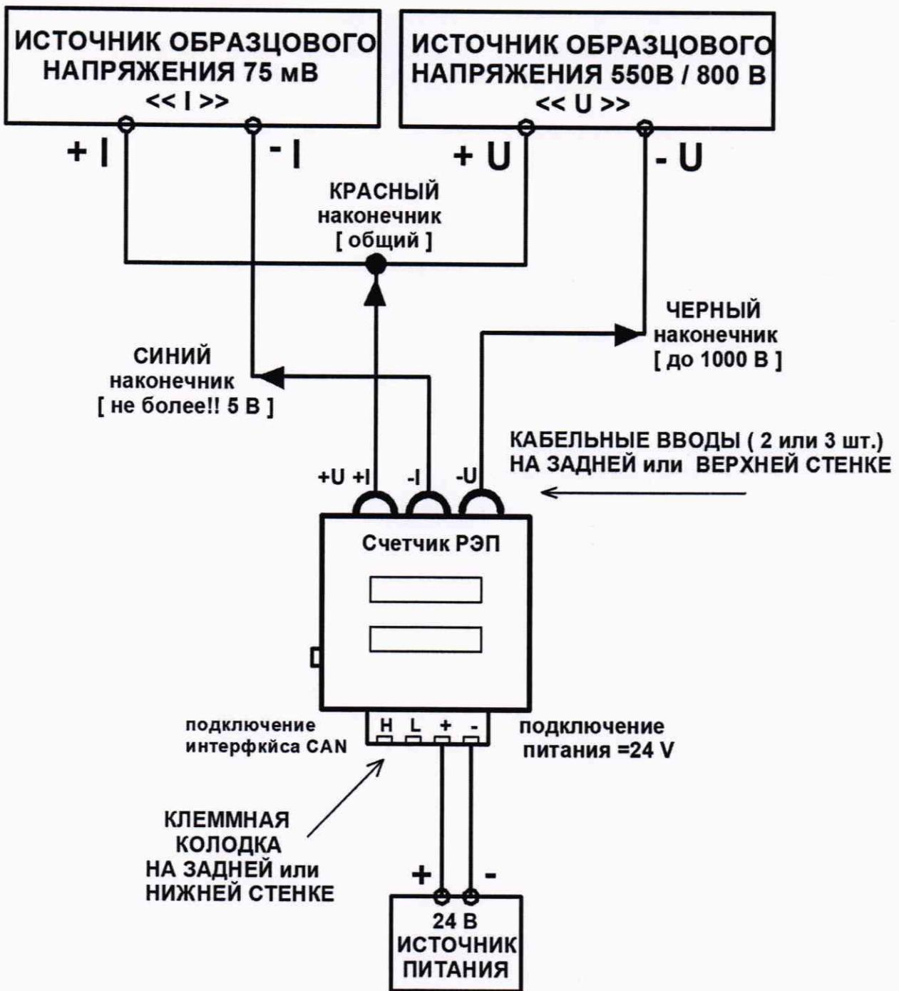
где источник образцового напряжения 75 мВ – калибратор многофункциональный 5520A;
