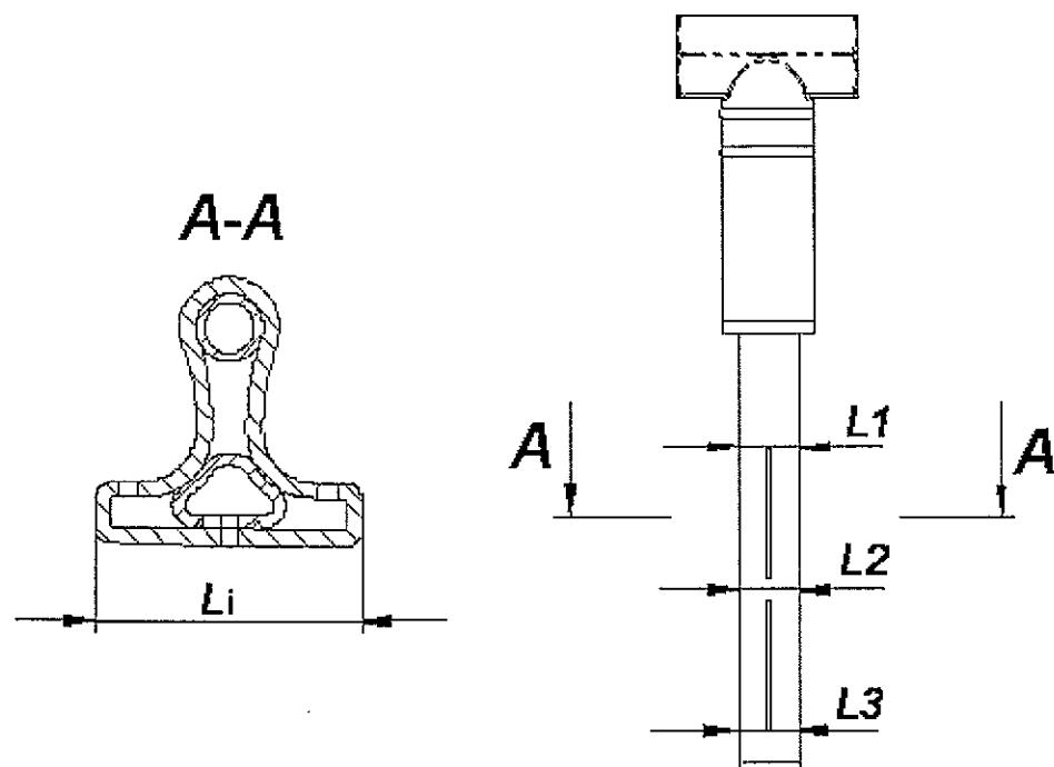
Ширину фронтальной части измеряют микрометром в трех сечениях (см. рисунок А.1). Размер  $L_1$  измеряют по краю верхней щели;  $L_2$  – по центру трубы, между центром верхней и нижней щели;  $L_3$  – по нижнему краю щели.
