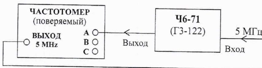
ГЗ-122 - генератор сигналов низкочастотный прецизионный;
