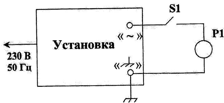
P1 – электросекундомер типа ПВ-53 (включенный на напряжение ~ 220 В);
