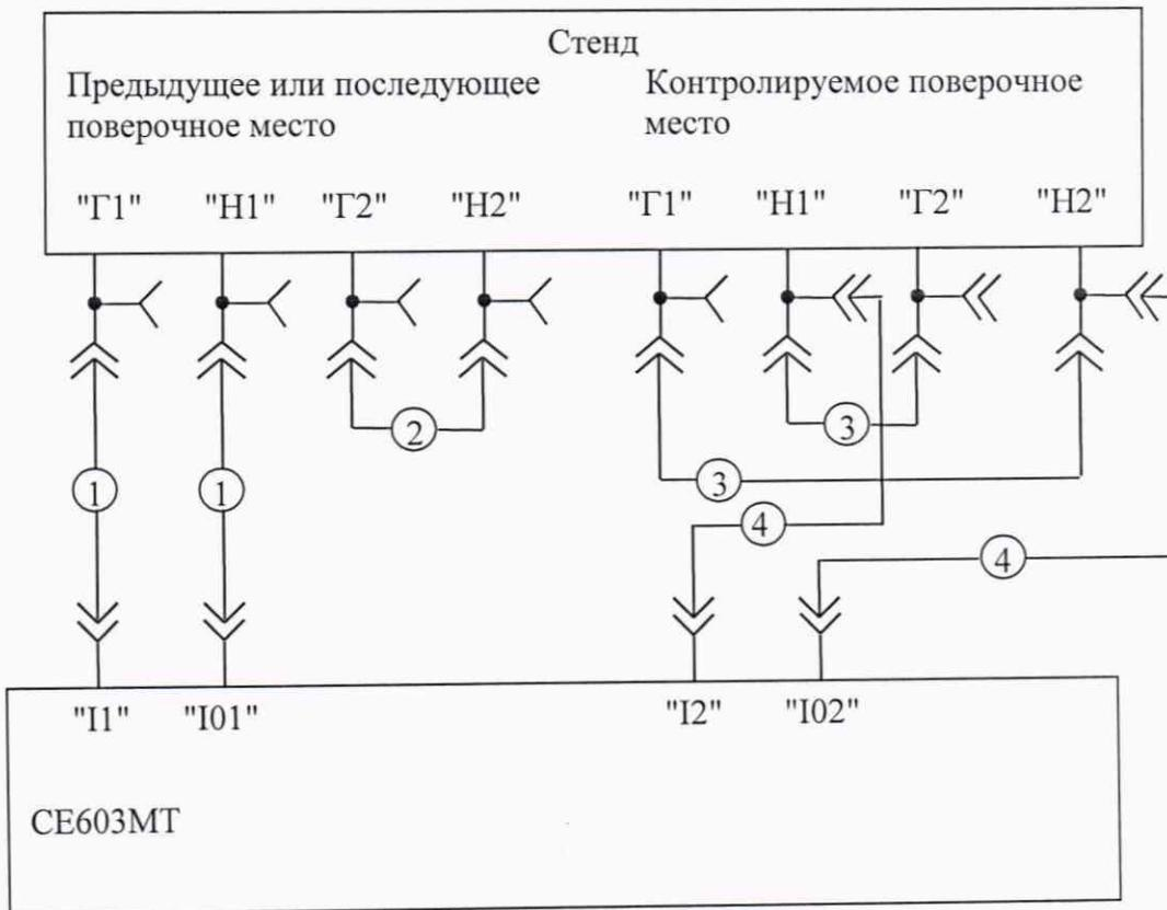
1 - Кабель 120 А с наконечниками 6 мм из комплекта ЗИП ваттметра-счетчика CE603M1.3.
