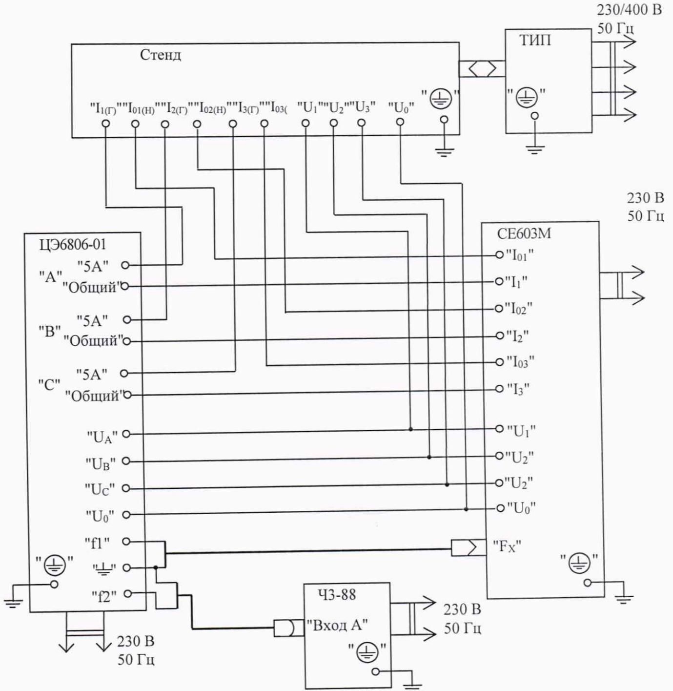
Стенд – стенд поверяемой установки СУ201М;
