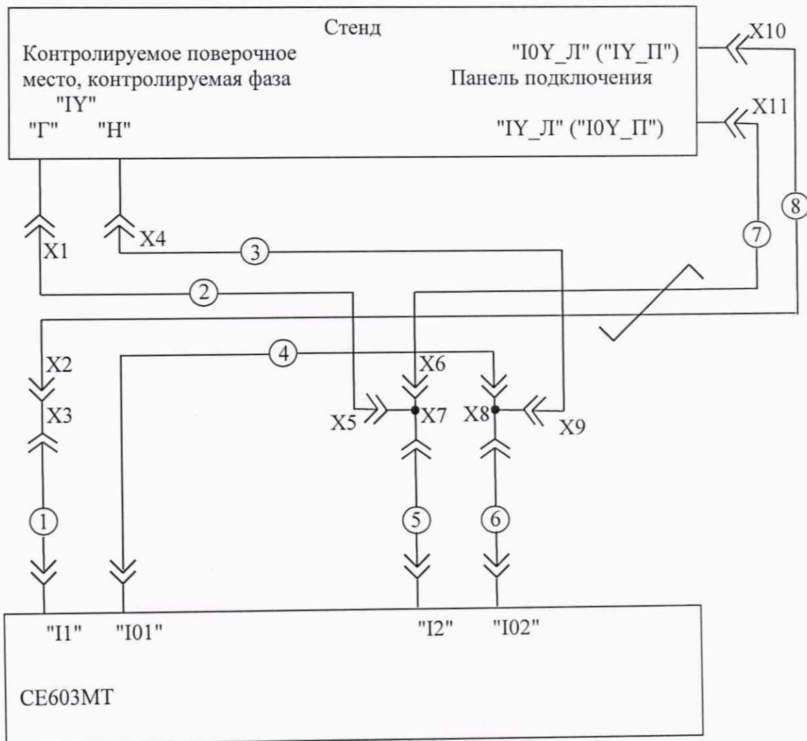
1, 4, 5, 6 - Кабель 120 А с наконечниками 6 мм из комплекта ЗИП ваттметра-счетчика СЕ603М1.3.
