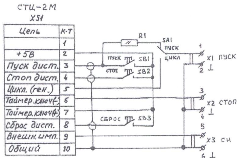
Перечень элементов электрической схемы пульта для поверки секундомера СТЦ-2М
