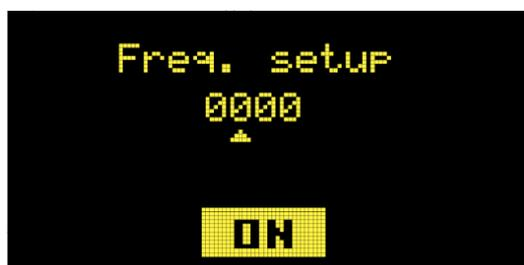
Рисунок 6 – Внешний вид дисплея анализатора в служебном режиме проверки частоты измерительного сигнала (сигнал не воспроизводится)
