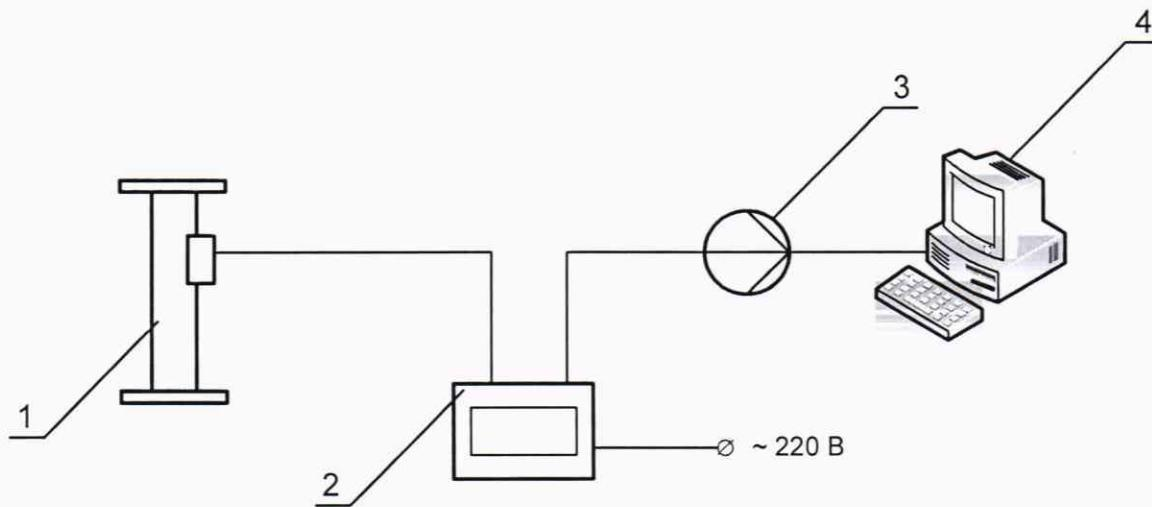
Рис. А1. Схема подключения электрических соединений влагомера АМ-ВОЕСН при по-
