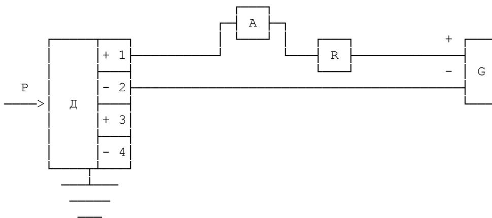
P - входная измеряемая величина (примеры подключения к датчику эталонных СИ входной величины и эталонных задатчиков давления приведены на [схемах 8](#) и [9](#) соответственно);
