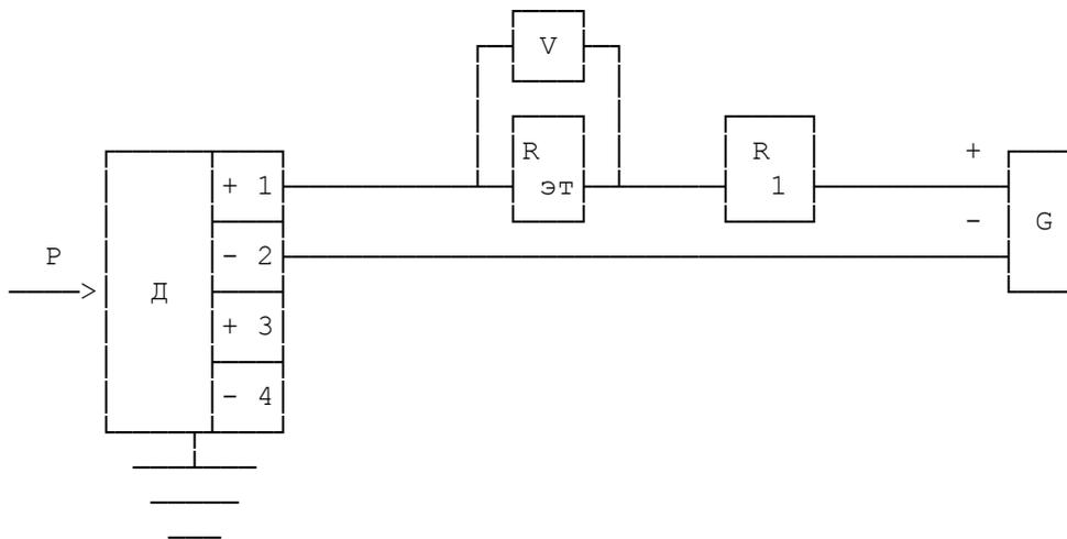
V - цифровой вольтметр или компаратор напряжения постоянного тока, указанные, например в табл. 1;
