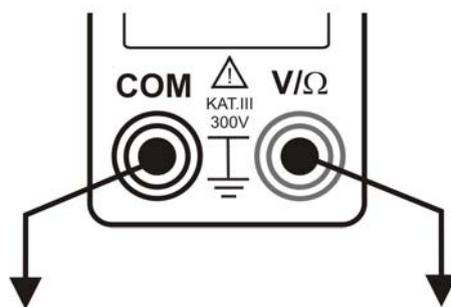
*К входным клеммам калибратора FLUKE 5520A*
