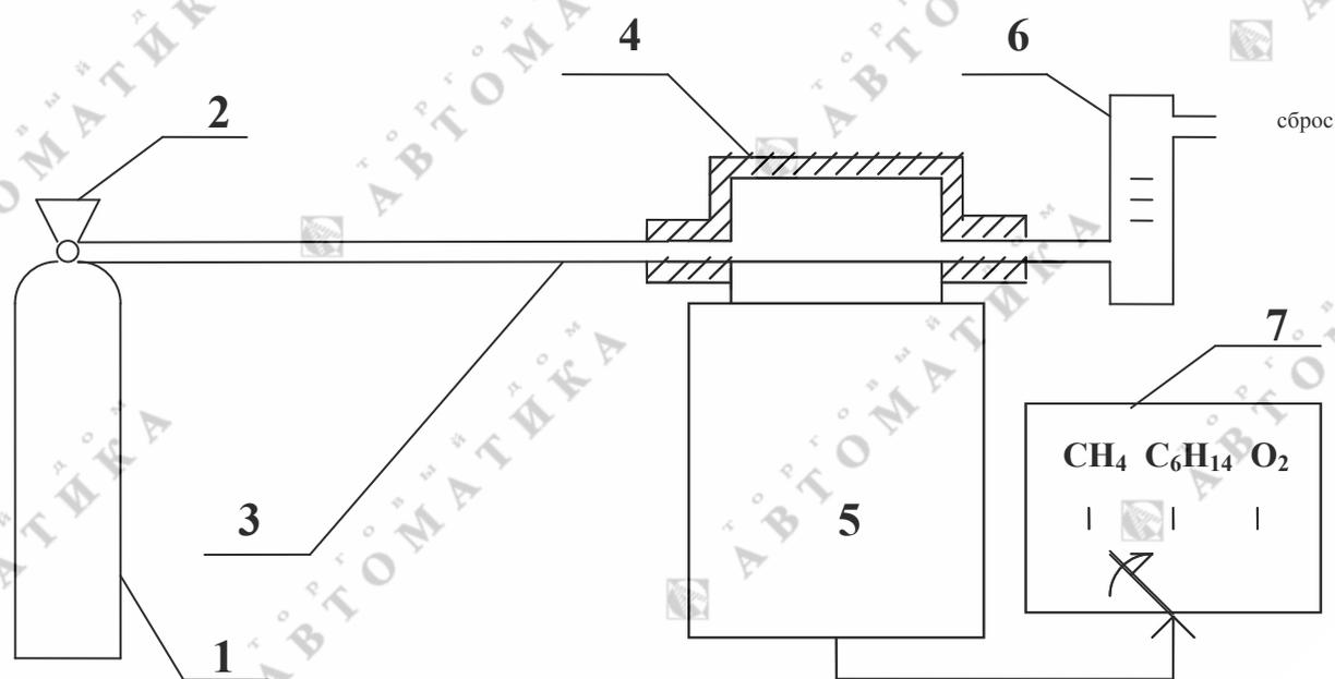
1 - баллон с ПГС; 2 - вентиль тонкой регулировки; 3 - соединительные трубки; 4 - адаптер; 5 - блок датчиков; 6 - ротаметр; 7 - блок индикации с переключателем каналов измерений (масштабы не соблюдены)
