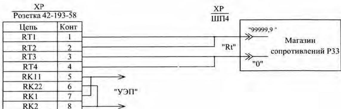
Схема установки для проверки параметров амперметрических каналов
