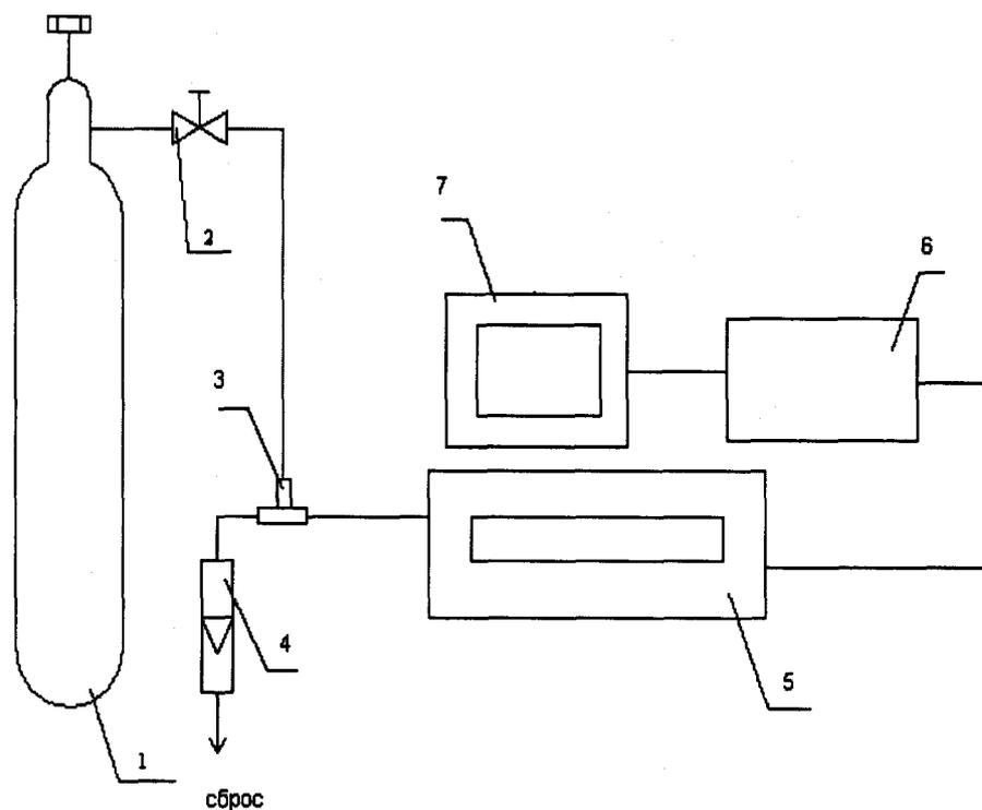
1 – баллон с ГС; 2 – вентиль точной регулировки; 3 - тройник; 4 – индикатор расхода (ротаметр);
