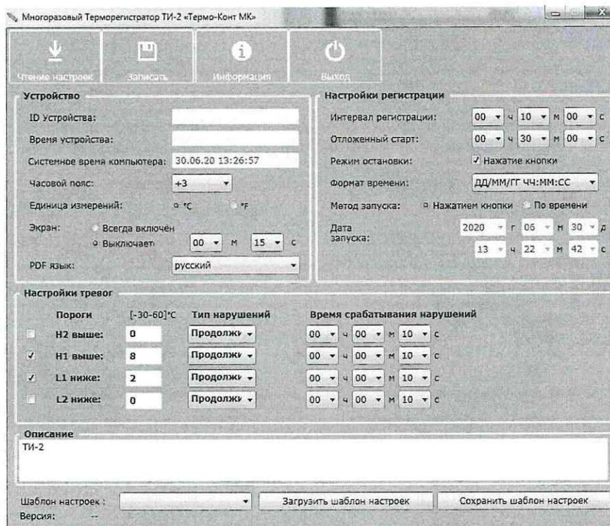
Шаг № 2. Подключить терморегистратор ПК с помощью встроенного USB-разъема. Нажать на вкладку «Чтение настроек». В окне автоматически определится ID-номер устройства и установленные настройки подключенного терморегистратора.
