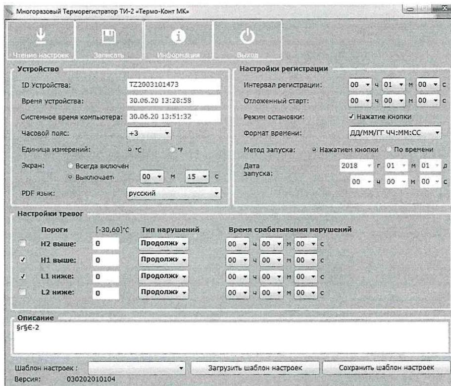
При необходимости можно произвести изменение настроек параметров терморегистратора. Для завершения записи настроек терморегистратора необходимо нажать на вкладку «Записать», после чего параметры будут загружены в терморегистратор. Аналогично проводится настройка параметров для всех поверяемых терморегистраторов.
