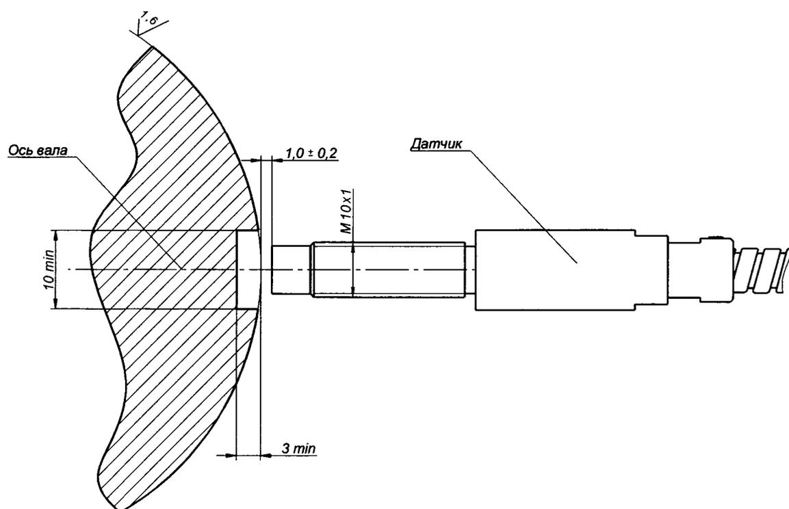
Рисунок Б.2 – Установка датчика IES400.010 в тахометрической установке
