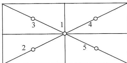
Гиры не должны выходить за пределы платформы. При каждом положении гирь регистрируются показания весов. Погрешности весов при нецентральном положении нагрузки рассчитывают по формулам (1) и (2).
