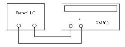
где: FASTWEL I/O – система ввода-вывода распределенная Fastwel I/O; КМ300 – компаратор-калибратор универсальный КМ300;
