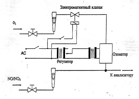
В режиме измерения NO проводится градуировка хемилюминесцентного газоанализатора по двум точкам: нулевой и не менее 4000 млн<sup>-1</sup>.
