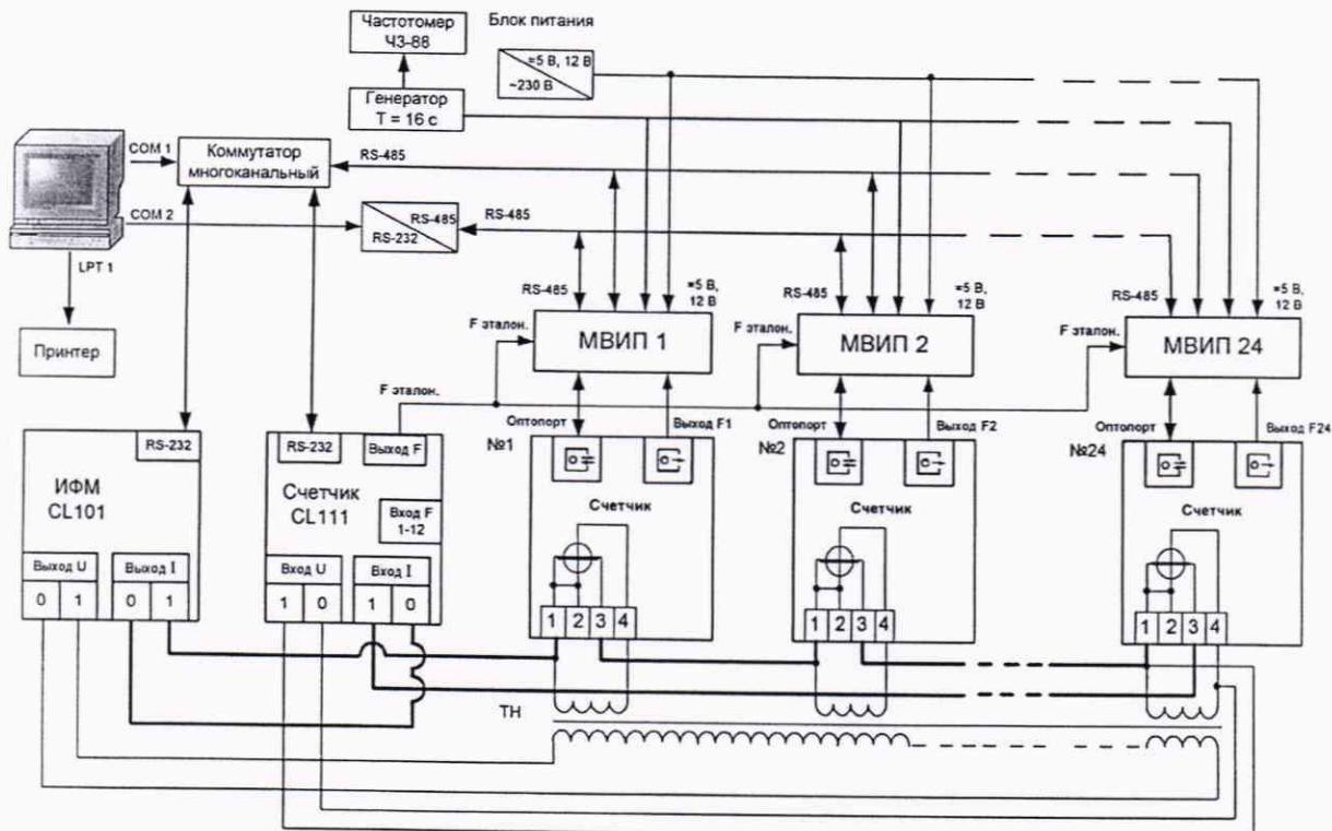
Состав установки: МВИП1...МВИП24 – модуль вычисления и индикации погрешности; счетчик №1....счетчик №24 – поверяемы счетчик электрической энергии на местах 1....24; счетчик CL111 - счетчик электрической энергии однофазный электронный эталонный CL111; ПК – компьютер с установленным программным обеспечением «Check; коммутатор многоканальный CL2018; генератор 16-ти секундных интервалов; блок питания; частотомер электронно-счетный ЧЗ-88; преобразователь интерфейсов
