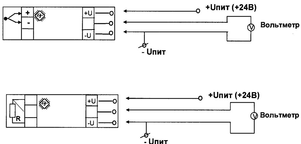
Знаки "+" , "-" указывают требуемую полярность т.э.д.с. термопары при ее соединении с НУ.
