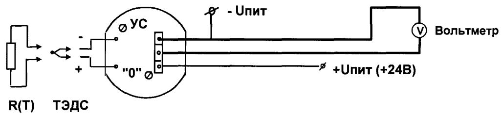
Знаки "+" , "-" указывают требуемую полярность т.э.д.с. термопары при ее соединении с НУ. "0", "УС" – подстроечные резисторы для коррекции зависимости температура-напряжение.
