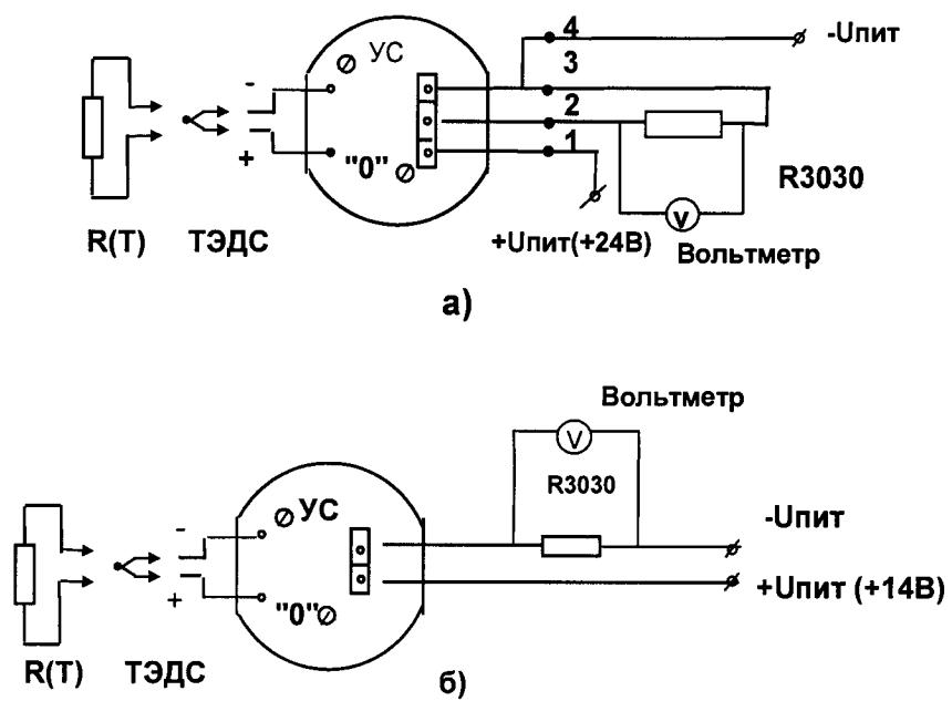
Знаки "+" , "-" указывают требуемую полярность т.э.д.с. термопары при ее соединении с НУ.
