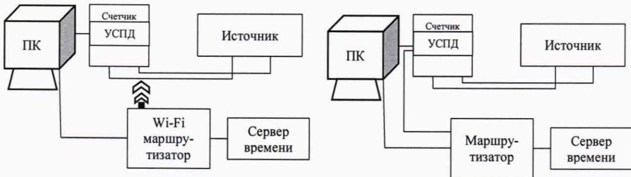
а) схема подключения для следующих исполнений УСПД (с применением интерфейса связи Wi-Fi): 3021-01, 3021-03, 3021-04, 3021-06
