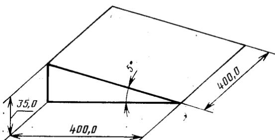
Приспособление представляет собой наклонную плоскость с углом наклона 35°, которое устанавливают на горизонтальной поверхности поверочного стенда или стола. Приспособление может быть изготовлено из любого металла (из алюминия или алюминиевых сплавов). Его собирают из отдельных элементов (пластины и боковых укосин) или отливают в виде полой детали. Наклонную поверхность обрабатывают соответствующим образом для придания ей плоскости.
