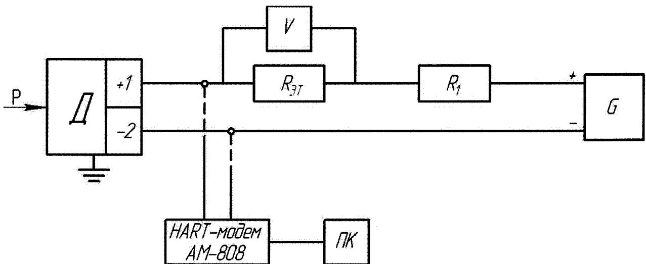
V – цифровой вольтметр или компаратор напряжения постоянного тока, указанные, например, в таблице 2;
