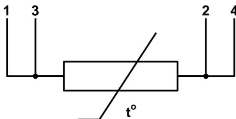
Рис.1. Схема соединений ТПС.
