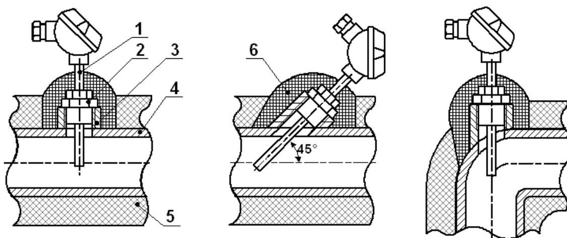
1 – термопреобразователь сопротивления; 2 – защитная гильза;
