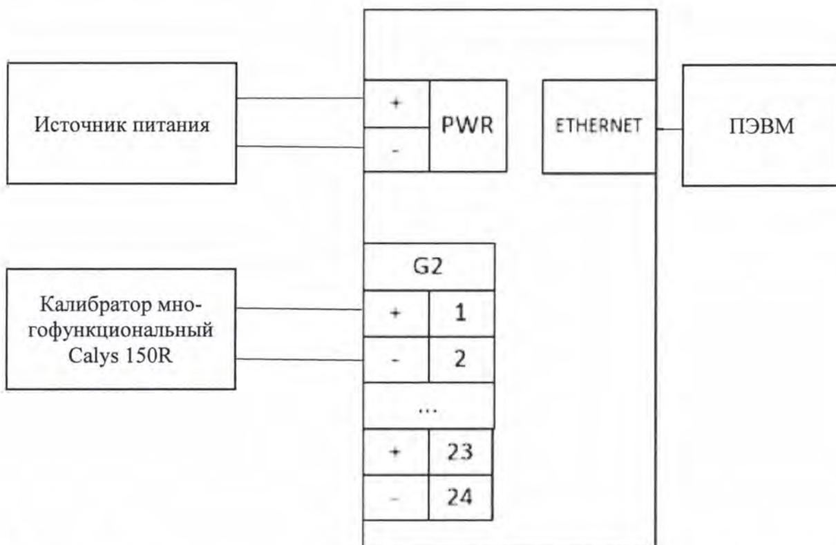
Рисунок 2 – Схема определений приведенной (к диапазону измерений) погрешности измерения напряжения постоянного тока
