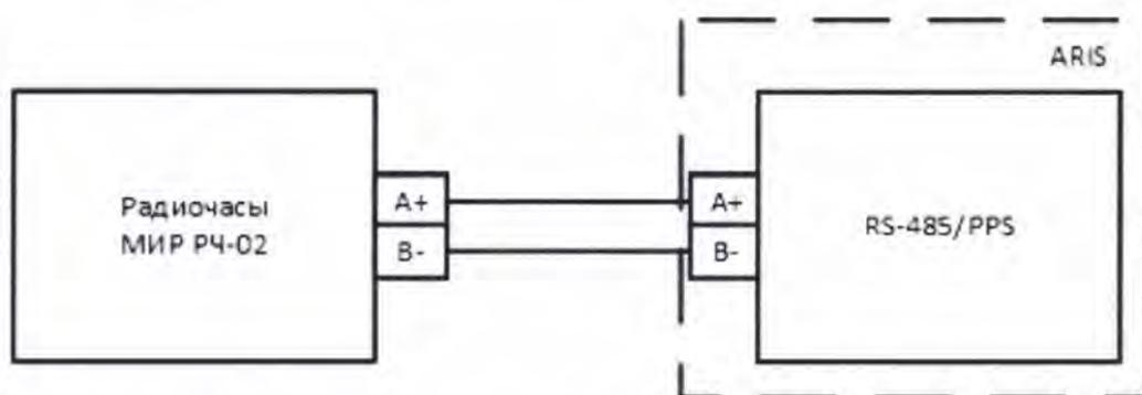
Рисунок 4 – Схема определения абсолютной погрешности внутренних часов
