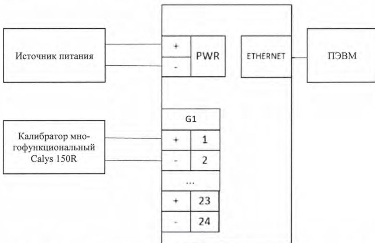
Рисунок 3 – Схема определения приведенной (к диапазону измерений) погрешности измерений силы постоянного тока
