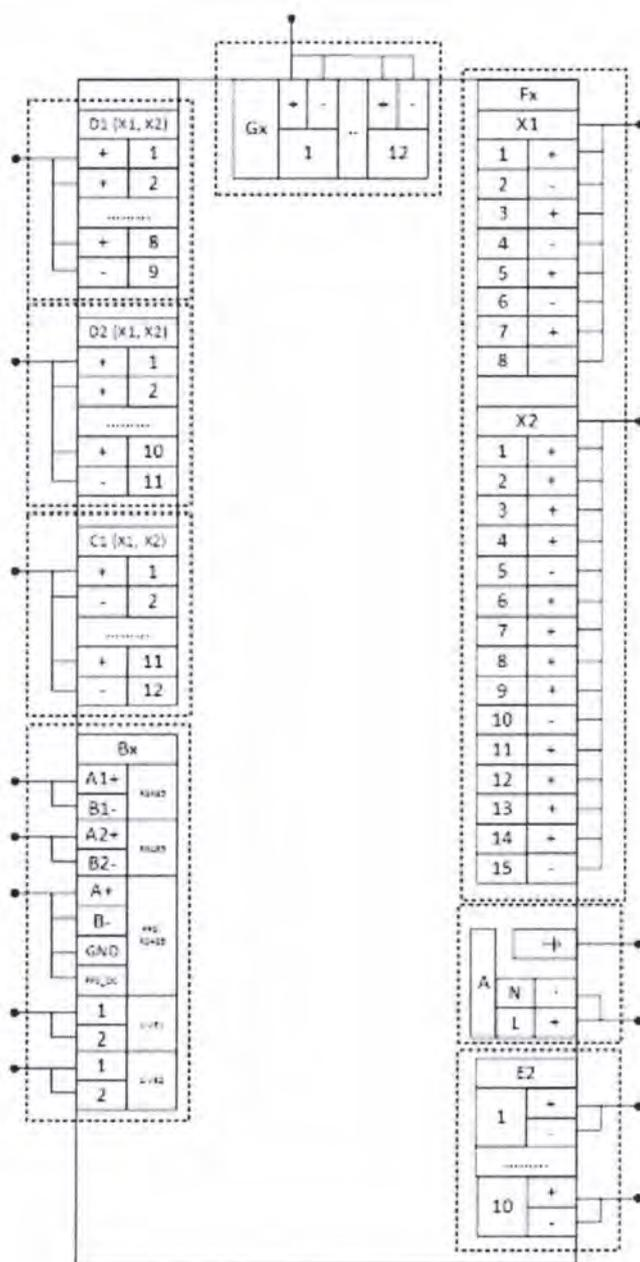
Рисунок 1 – Схема соединений для проведения испытаний изоляции
