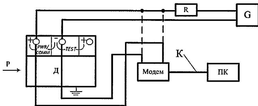
Модем – устройство связи и преобразования сигналов USB-HART Модем;
