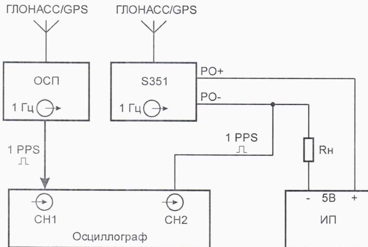
ОСП – Опорный синхронизирующий приемник ОСП-2,
