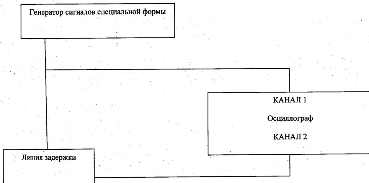
Параметры импульсного сигнала, устанавливаемые на генераторе сигналов специальной формы: Однополярный положительный, амплитуда 1 В, прямоугольная форма импульса, длительность импульса 10 мкс; период следования 1000 Гц.
