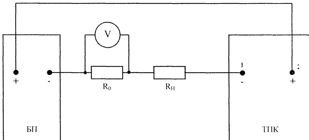
Рис.1 Термопреобразователь ТПК с выходным сигналом ( 4-20 ) мА.
