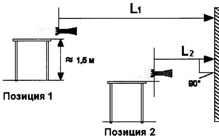
устанавливают в позицию 1 на расстояние L<sub>1</sub>, проводят измерения и записывают в протокол измеренные значения расстояния L и Ly в позиции 1 по рулетке (L) и с дисплея модуля индикации и настройки уровнемера (Ly).
