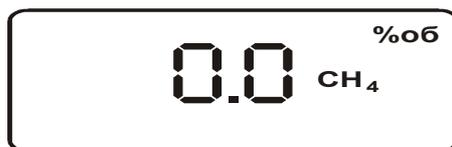
Рисунок 5 Символы на ЖКИ, соответствующие режиму измерения метана
