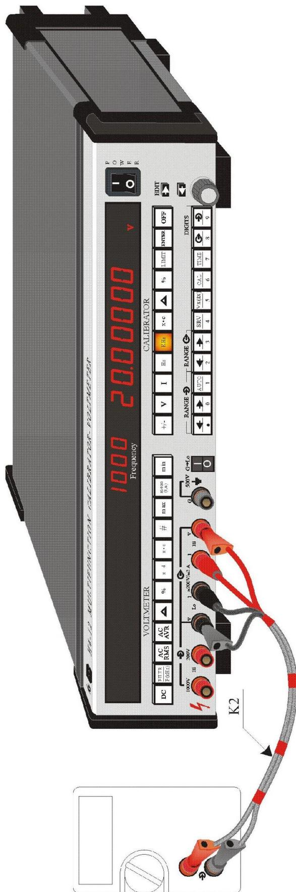
Рисунок 8.14 – Режим калибратора постоянного и переменного напряжения, пределы «0,2 V», «2 V», «20 V» и «200 V»
