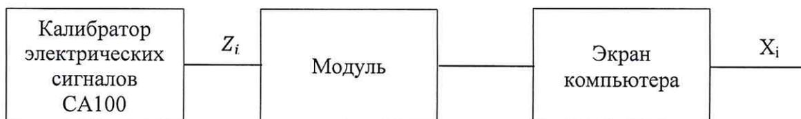
Рисунок 1 - Схема подключений при определении погрешностей каналов, реализующих линейное аналого-цифровое преобразование сигналов силы постоянного тока
