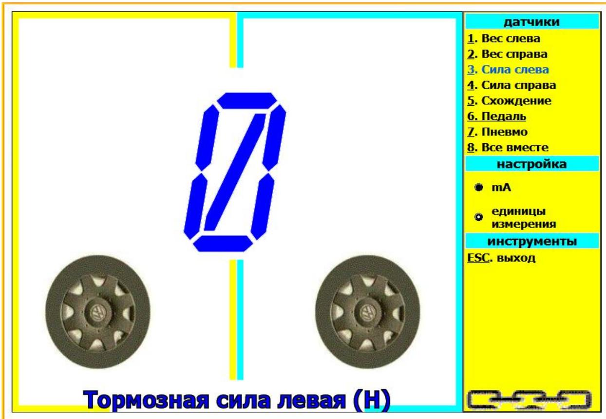
Рисунок 4. Окно датчика тормозной силы левой стороны.
