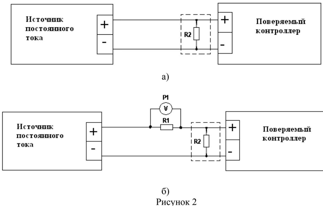
а) при использовании в качестве эталона калибратора постоянного тока.
