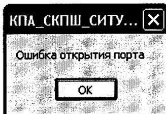
Рисунок 4 - Сообщение, появляющееся на экране в случае отказа в доступе к последовательному порту
