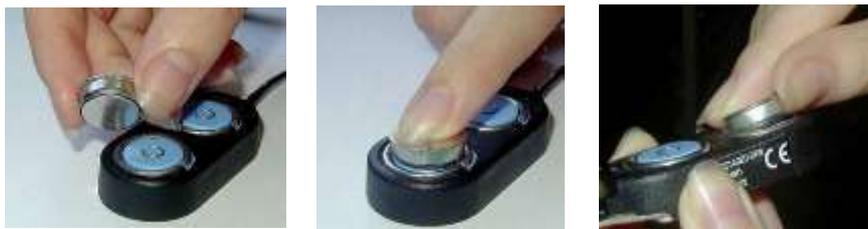
Рисунок 2.9 – Операции установки регистратора в гнездо приёмного зонда
