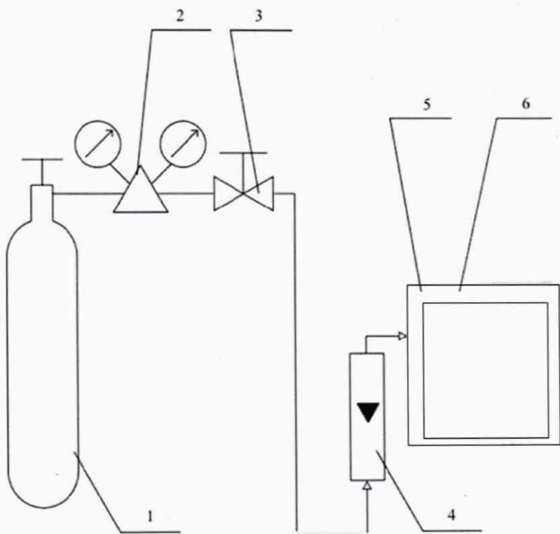
Рисунок 1 – Рекомендуемая схема подачи ГС на вход газоанализаторов
