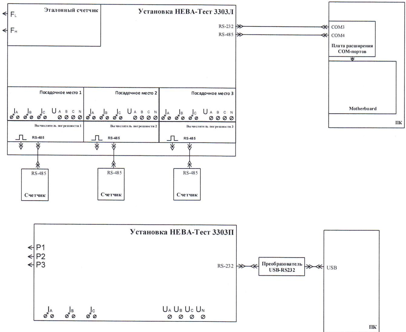
Рис. А3 Схемы подключения установок к ПК
