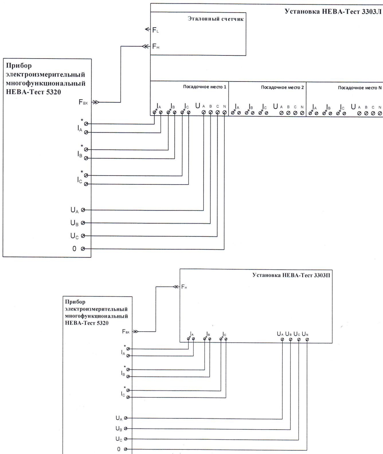
Рис. А1 Схемы подключения прибора НЕВА-Тест 5320 к лабораторному и переносному вариантам исполнения Установки в режиме проверки Установки
