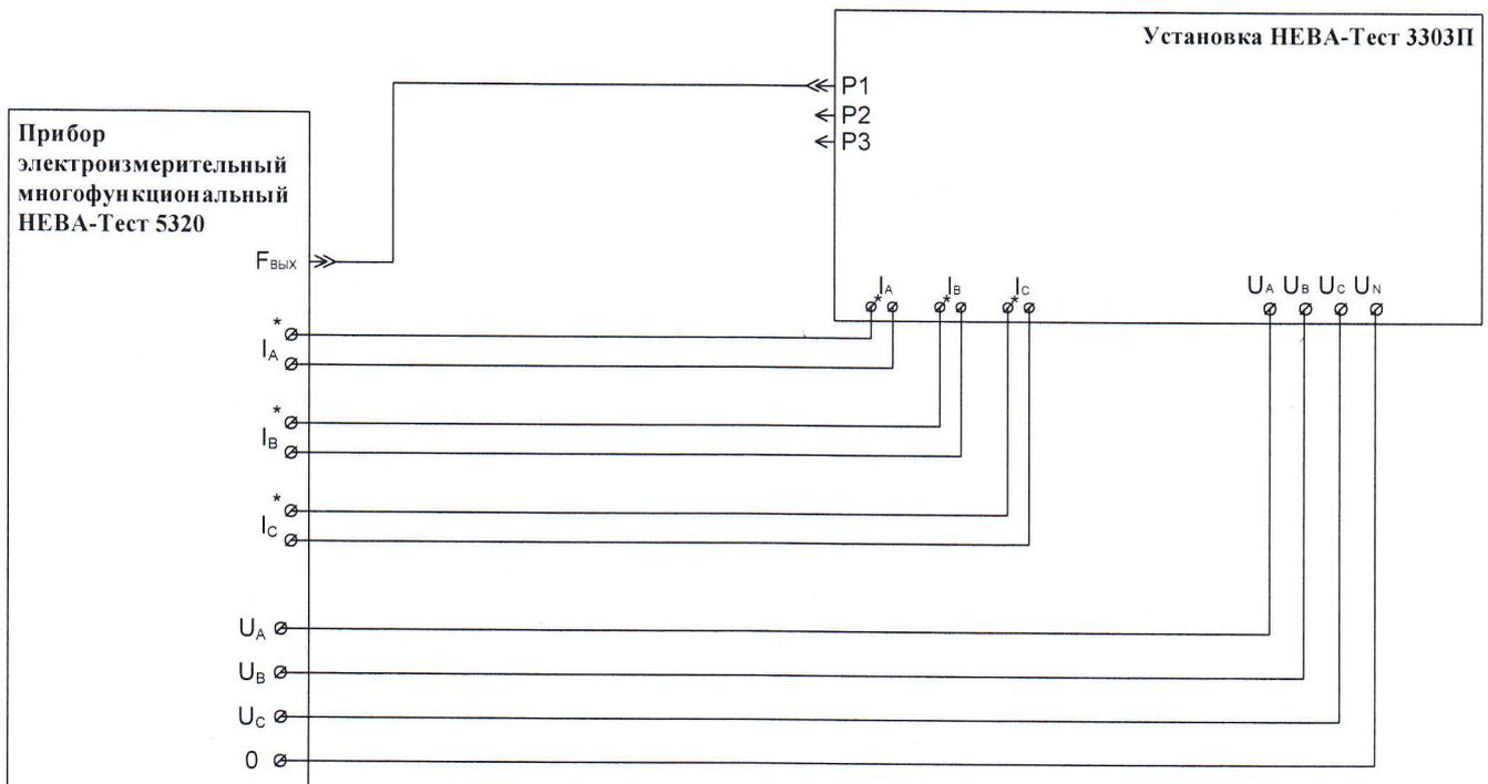
Рис. А2 Схемы подключения прибора НЕВА-Тест 5320 к лабораторному и переносному вариантам исполнения Установки в режиме проверки прибора НЕВА-Тест 5320
