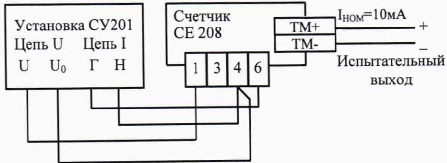
Схема подключения одноэлементного счетчика к установке СУ201 для определения погрешности при прохождении тока через цепь "фазы".
