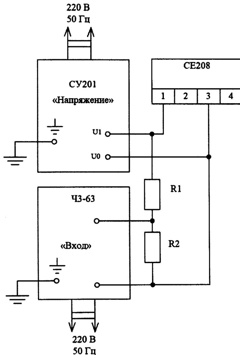
ЧЗ-63 – частотомер электронно-счетный;
