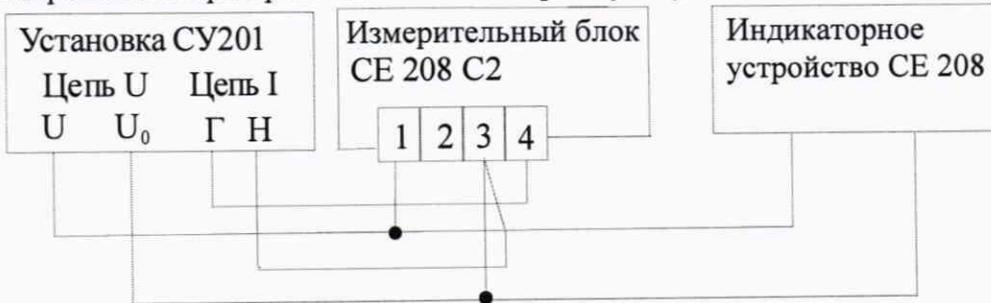
Схема подключения счетчика в корпусе С2 к установке СУ201 для определения погрешности при прохождении тока через фазную и нулевую цепь тока
