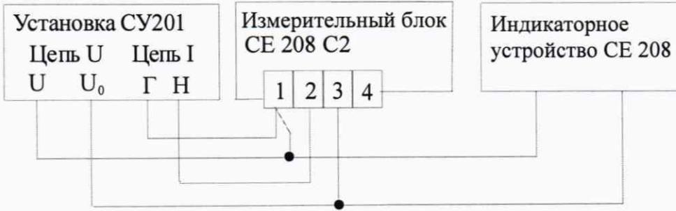
Схема подключения счетчика в корпусе С2 к установке СУ201 для определения погрешности при прохождении тока через нулевую цепь тока
