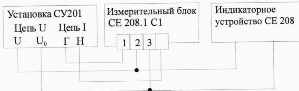
Примечание. Номера контактов нанесены на корпусе.
