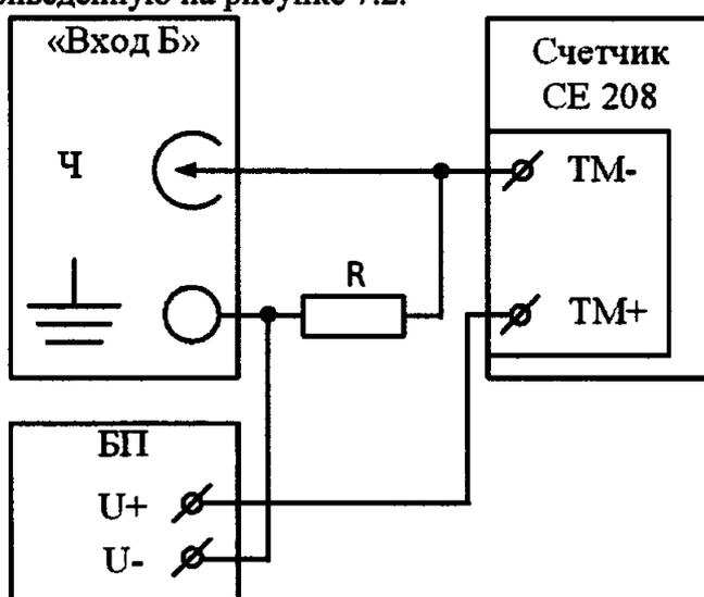
Ч – частотомер электронно-счетный ЧЗ-63;
