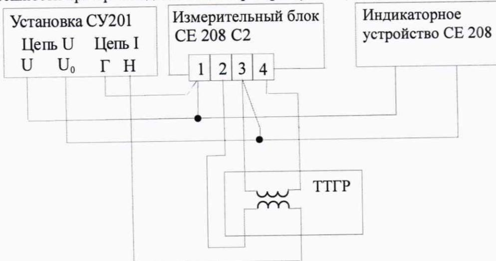
Схема подключения счетчика с одним измерительным элементом в корпусе С1 к установке СУ201 для определения погрешности при прохождении тока через фазную цепь тока
