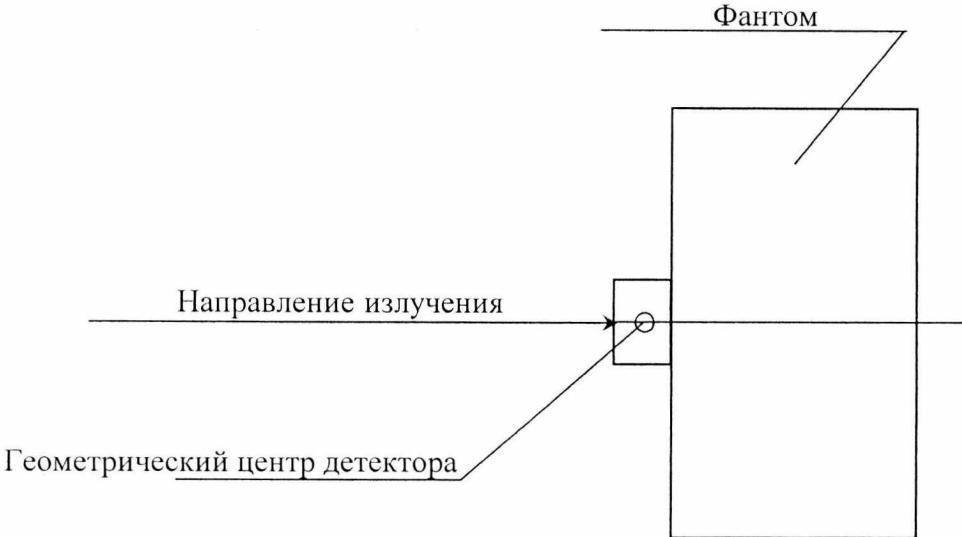
Рисунок 1 – Способ установки дозиметра с фантомом на поверочную дозиметрическую установку.
