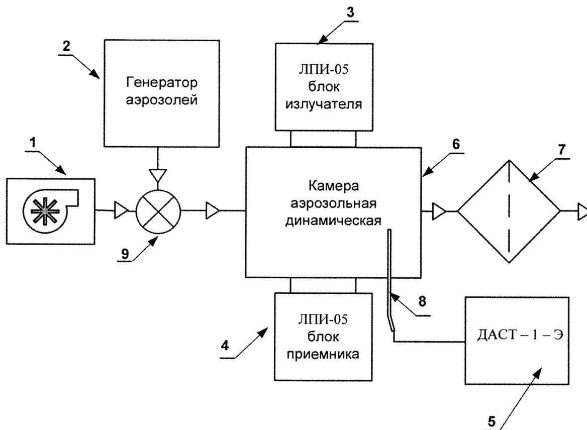
1. Вентилятор ATLAS COPCO LE/LT-22; 2. Генератор аэрозоля; 3. Пылеизмеритель лазерный ЛПИ-05 (блок излучателя); 4. Пылеизмеритель лазерный ЛПИ-05 (блок приемника); 5. Анализатор «ДАСТ – 1 – Э»; 6. Камера аэрозольная динамическая; 7. Воздушный фильтр; 8. Пробоотборная трубка камеры аэрозольной динамической; 9. Смесительная камера.
