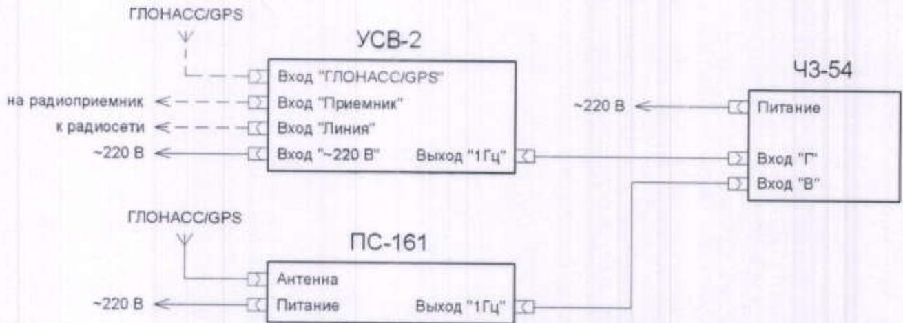
Рисунок А – Функциональная схема подключения оборудования для проведения поверки
