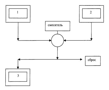
Рис.1. Газовая схема для определения основной погрешности газоанализатора
