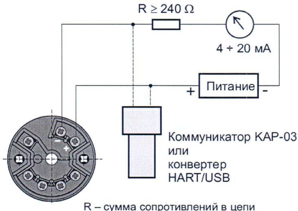
Возможно снятие показания как с помощью миллиамперметра (4 – 20 мА), так и на экране персонального компьютера (ПК) с установленной программой («Report») через коммуникатор.
