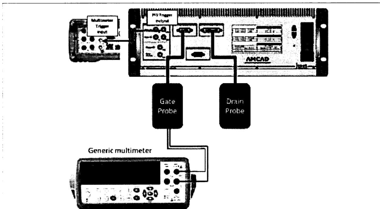
Рисунок 7.3.1 – Схема соединений для измерения напряжения зондом затвора
