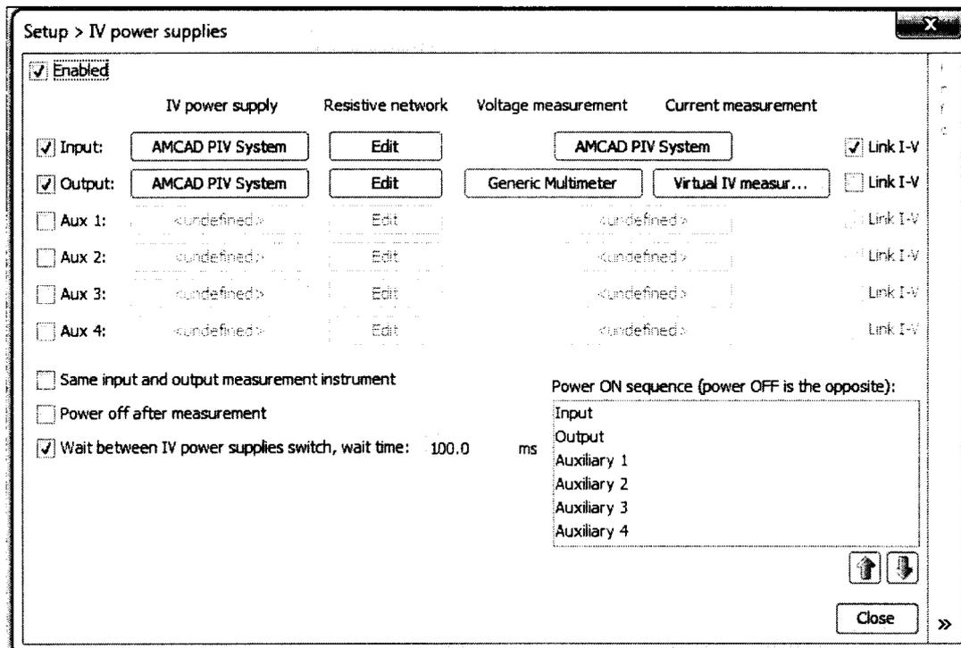
Рисунок 7.3.3 - Окно Setup > IV power supplies после конфигурации
