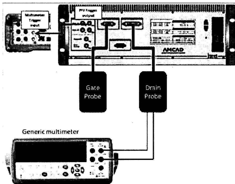
Рисунок 7.5.1 – Схема соединений для измерения напряжения зондом стока
