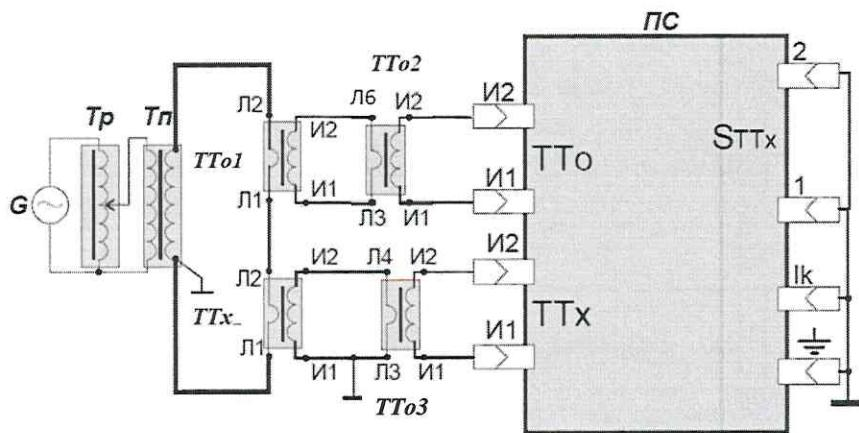
**G**~ - сеть; **T<sub>p</sub>** - регулировочный трансформатор источника тока; **T<sub>n</sub>** - источник тока;
