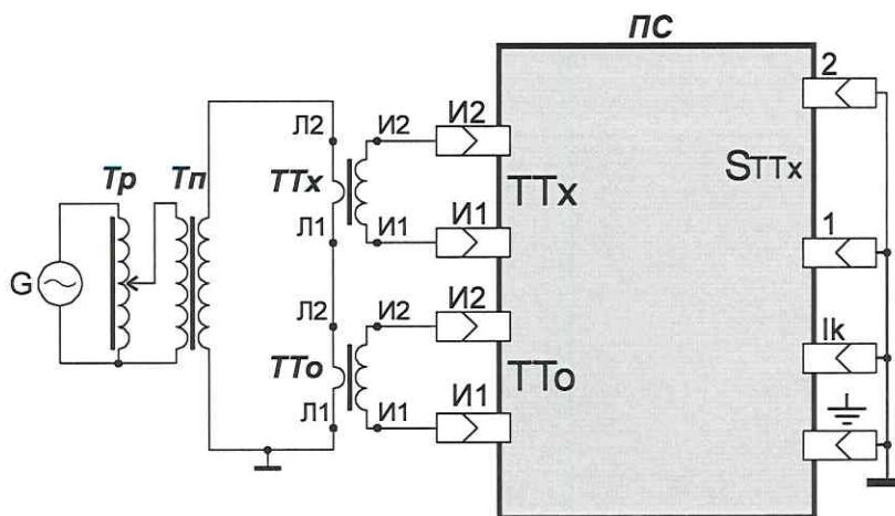
$G$  - сеть;  $Tp$  - регулировочный трансформатор источника тока;  $Tp$  - источник тока;  $TTx$  - поверяемый трансформатор ТТИ-200;  $TTo$  - трансформатор тока измерительный лабораторный ТТЭ-3000.5; Л1, Л2 – контактные зажимы первичной обмотки; И1, И2 – контактные зажимы вторичной обмотки;  $ПС$  - прибор сравнения КНТ-05А
