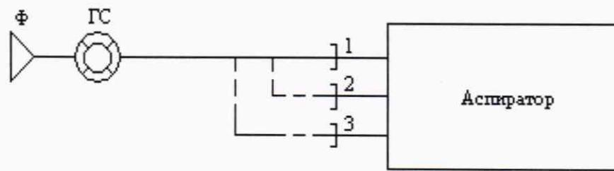
$\Phi$  – фильтродержатель с фильтром АФА ВП-2;
