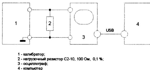
Рисунок А.1 - Схема соединений для определения погрешности заряда генерируемых электрических импульсов
